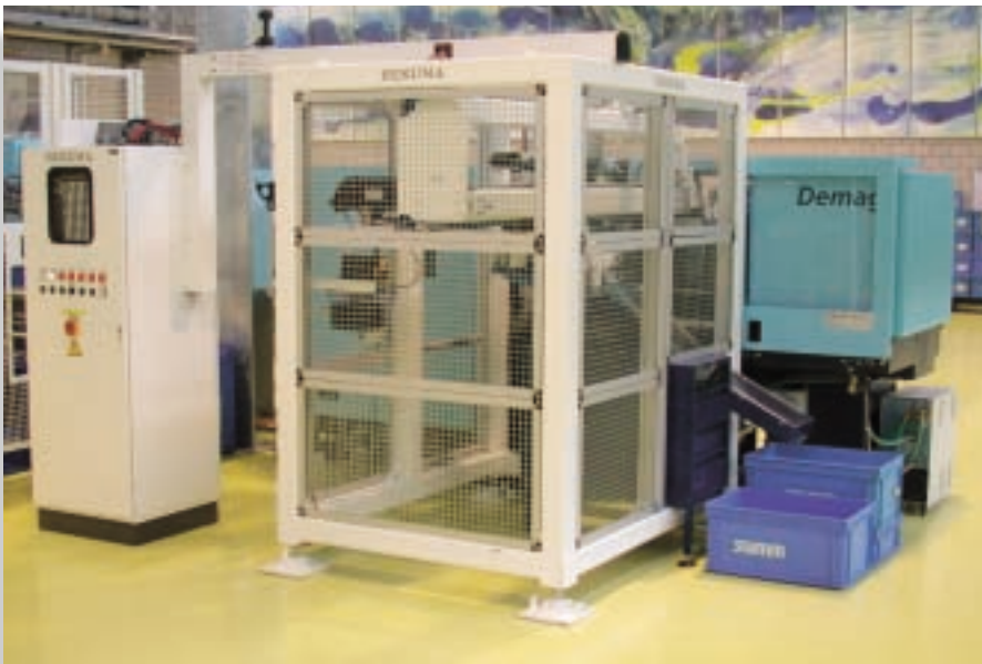
Modifizierte Standardmaschine mit Automatisierung und 14mm Schnecke
