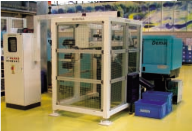
60 Millionen Kugelschreiberspitzen entstehen jährlich in der Fertigungszelle mit einem 32fach-Heißkanalwerkzeug und Hekuma Entnahme. Als Maschine kommt eine Ergotech Demag concept 25-35 zum Einsatz (Bilder: Stamm; Demag Ergotech)
