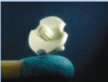
Zahnrad: Material POM, Zahnradkranzdurchmesser 1,4, Zähnezahzahl 12, Modul 0.1 mm
