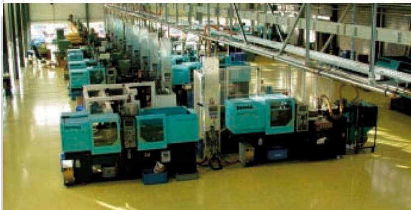
Gespritzt werden die Winzlinge bei Stamm vor allem auf Standardmaschinen von Demag Ergotech, ausgestattet mit einer Mikrospritz-einheit (Bilder: Stamm)
